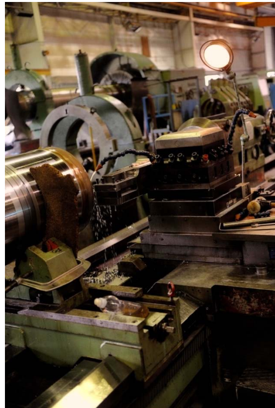
Illustration 10 : Zone d'usinage d'une pièce de grande taille avec machine à commande numérique utilisant des fluides de coupe (Auteur : Gaël Kerbaol, INRS)
