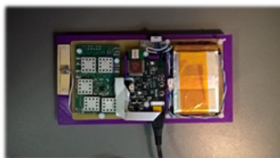
Détails des cartes électroniques intégrées dans la sur-coque DEVIN
